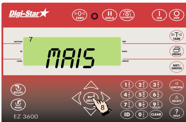
7. L'indicateur de pesage affiche le nom et la quantité du composant à charger. Pendant le chargement du composant, l'indicateur comptera à rebours jusqu'au zéro.
