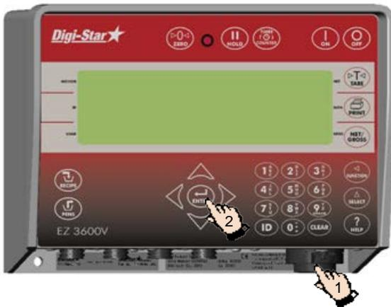
1. Insérez la clé USB dans l'indicateur de pesage.
