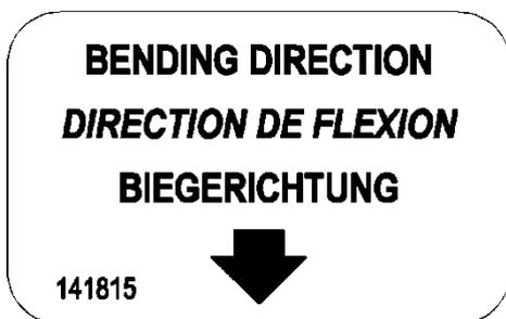
Faites attention à la direction de la flèche quand vous montez le capteur de charge.
