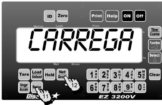
9. No mostrador aparece o texto *CARREGADO* para mostrar que o ingrediente está armazenado na memória permanente do indicador de pesagem. Todas as informações armazenadas na memória permanente permanece em caso de falta de energia eléctrica.
