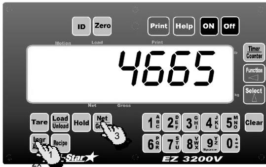
1. Pressione 2× em **Ingr Accum** quando uma carga já estiver carregada com uma receita programada e o Delay Timer estiver em *MANUAL*.
