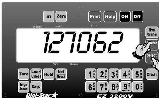
Quando o correcto valor SETUP estiver no mostrador, pressione **On** para continuar com o valor de calibração. O texto CAL aparece no mostrador, seguido do valor CAL.
