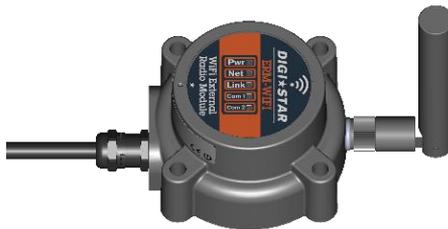
Abb. 5. Horizontale Anbringung mit richtiger Antennenstellung
