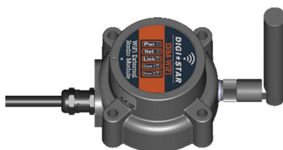
Figura 5. Montagem horizontal do ERM-Wi-Fi com orientação correta da antena
