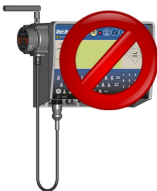
Figura 4. Orientação incorreta da antena do ERM-Wi-Fi
