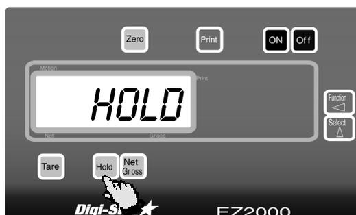
Nel modo di pesatura HOLD (opzione) si può bloccare il peso. La lettura del peso non cambierà durante gli spostamenti del sistema. Allora non ci sarà una deriva dello zero.
