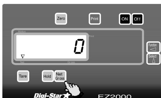
Il modo di pesatura netto mostra il cambio del peso dopo l'esecuzione di una taratura (TARE). TARE realizza una messa a zero temporanea con questo valore di pesatura.
