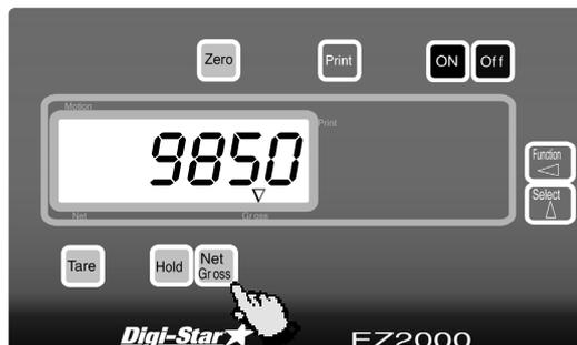
Il modo di pesatura lordo mostra il cambio del peso fin dall'ultima messa a zero del sistema.
