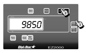
Pulse y después on para activar el reloj mezclador durante el tiempo graduado.
