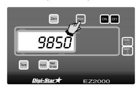
Pulse Print. Los datos de peso se transmiten a la impresora.
