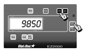
Pulse on. El indicador levanta la alarma del reloj mezclador y vuelve a la modalidad de pesaje.
